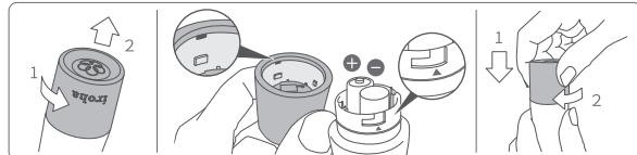
●為避免電池彈出，務必在電池蓋朝上狀態下再行開啟電池蓋。
